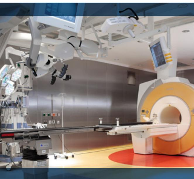
*(großes Bild)* Colorex® besteht aus leitfähigen beschichteten Chips, dieser Aufbau schützt dauerhaft vor unerwünschten statischen Entladungen.
