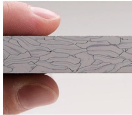
Colorex® ist ein durch extremen Hochdruck verpresster Bodenbelag mit kompakter Oberfläche. Bei dem speziellen Herstellungsverfahren wird der Vinylbelag zunächst als Bahnenware gefertigt und dann in einzelne, kleine sogenannte „Chips“ geschnitten. Diese werden anschließend mit einer leitfähigen Klebstoffsubstanz ummantelt. Das macht den Zusatz von chemischen Antistatika komplett verzichtbar.
