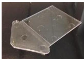
Die nachfolgenden Ergebnisse wurden im Rahmen des FFG Projektes HygO im Zeitraum von Oktober 2013 – September 2015 ermittelt. Die orientierende Untersuchung wurde auf Labormuster gegenüber definierten Wirkstofflösungen durchgeführt. Das Labormuster aus Polycarbonat (PC) wurde auf Beständigkeit in einem Langzeitversuch getestet.
