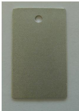
Die nachfolgenden Ergebnisse wurden im Rahmen des FFG Projektes HygO (841084) im Zeitraum von Oktober 2013 – September 2015 ermittelt. Die orientierende Untersuchung wurde auf Labormuster gegenüber definierten Wirkstofflösungen durchgeführt. Das Labormuster aus Aluminium mit gestrahlter Oberfläche wurde auf Beständigkeit gegenüber in der Praxis repräsentativen Desinfektionswirkstoffen in einem Langzeitversuch getestet.
