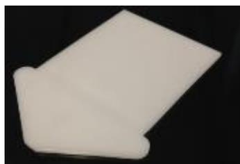
Die nachfolgenden Ergebnisse wurden im Rahmen des FFG Projektes HygO im Zeitraum von Oktober 2013 – September 2015 ermittelt. Die orientierende Untersuchung wurde auf Labormuster gegenüber definierten Wirkstofflösungen durchgeführt. Das Labormuster aus Polyoxymethylen (POM) wurde auf Beständigkeit in einem Langzeitversuch getestet.
